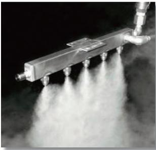
オープン後の食感を向上させるために50 μm以下の細かい霧で調湿します。
