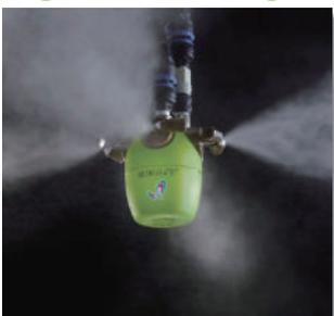
ドライフォグが空中を浮遊し包装機周辺で発生しやすい静電気によるトラブルを防止します。
